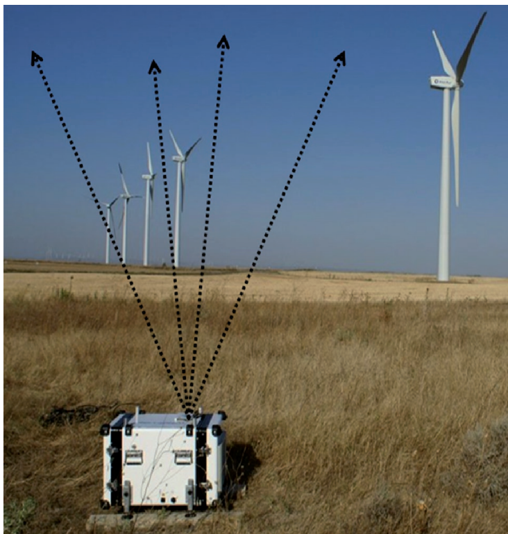
4. Lidar WINDCUBE sur site éolien. Les flèches indiquent les directions des quatre faisceaux laser, utilisés pour restituer les trois composantes du vecteur vent. Le WINDCUBE™ a été développé par Leosphere, avec une technologie ONERA pour ce besoin précis. Il utilise un amplificateur laser à fibre optique à 1550 nm, issu des technologies de télécommunications. Ce lidar a été testé et validé par des organismes indépendants, et a obtenu des performances inégalées en précision de vitesse (0,1 m/s).
