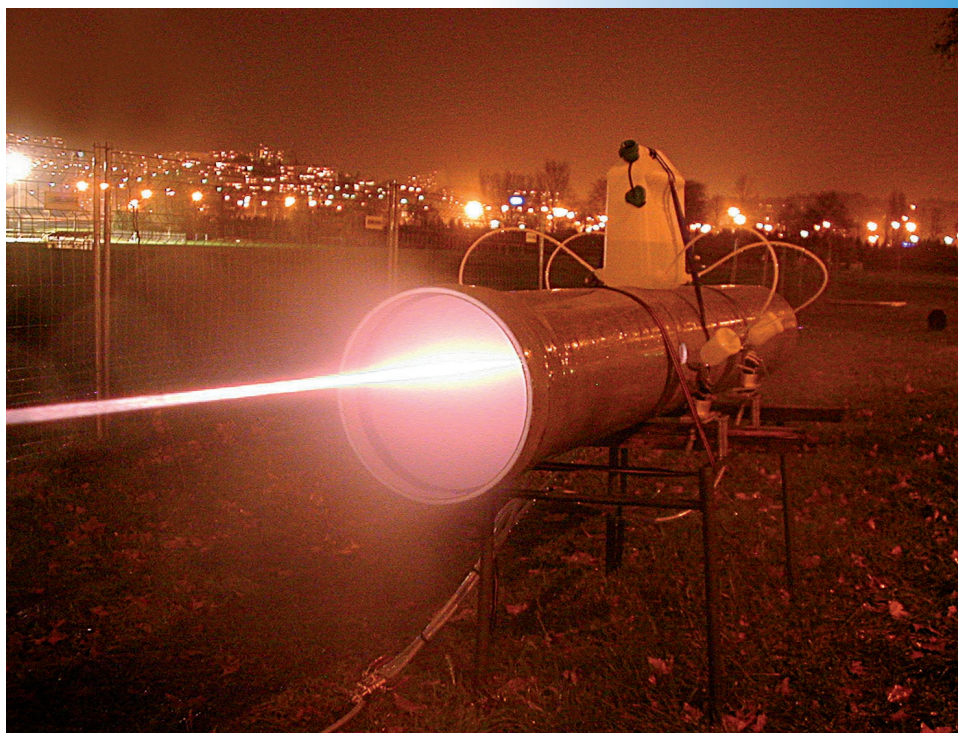
Détection de simulants d'aérosols biologiques avec le Lidar Téramobile ® : le faisceau laser arrive de la gauche, illumine le brouillard produit dans le tube et permet de l'analyser. © CNRS Photothèque / Université Jean Moulin Lyon 3 / GRATIE Alexis.
