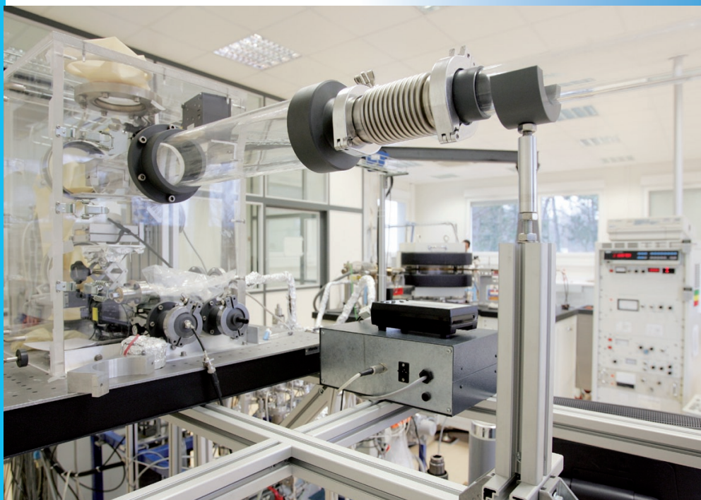
Système expérimental d'extraction des gaz par ablation laser, permettant de connaître leur composition en fonction de la profondeur dans l'échantillon (CRPG, Vandœuvre-lès-Nancy). © CNRS Photothèque / MANBERT Thierry.
