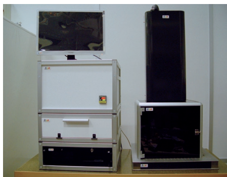
3. LIBS transportable commercialisée par IVEA sous licence CEA, et logiciel de traitement associé.
