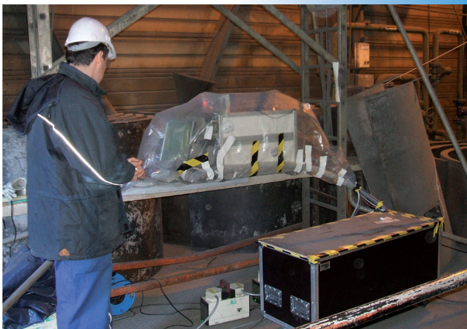
2. Analyse par LIBS de la qualité de l'air dans une fonderie (IVEA/INERIS)
