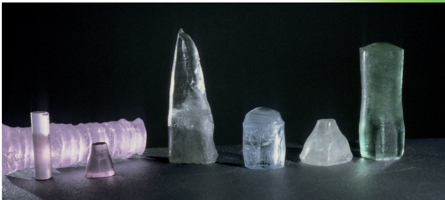
Cristaux de silicates de calcium et d'aluminium dopés par différentes terres rares, et utilisés comme matériaux lasers (CMCP, Paris). © CNRS Photothèque / DELHAYE Claude.
